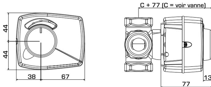
Dimensions d'installation pour les servomoteurs de la série ARA600 avec vannes de mélange ESBE des séries VRG100, VRG200, VRG300, VRB100 et VRH100
