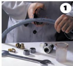
**1** Couper le tube bien proprement à 90°, à l'aide d'une pince spéciale. Aléser le tube avec l'alésoir R206
