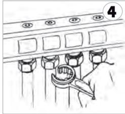
**4** Serrer l'écrou à refus à l'aide de la clef R131. Après les essais d'usage et les essais en température maximale admissible, on vérifiera le serrage des écrous.
