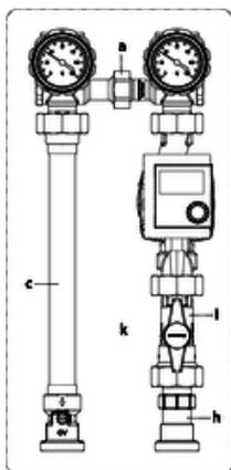
**Système de raccordement pour chaudières "Regumat S-180" DN 25 sans circulateur, avec robinet d'isolement à tournant sphérique et isolation universelle**
