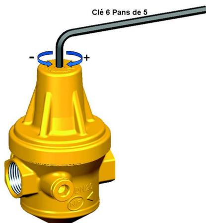
Pour augmenter la pression, introduire une clé Allen de 5 au niveau du haut du chapeau. Visser jusqu'à l'obtention de la pression désirée. Pour diminuer la pression, dévisser complètement la vis de réglage, ouvrir un robinet afin de permettre un écoulement et abaisser la pression dans le réseau. Refermer le robinet et visser jusqu'à l'obtention de la pression désirée. Le réducteur est réglable de 1 à 5.5 bar en aval pour une pression d'entrée de 8 bar.
