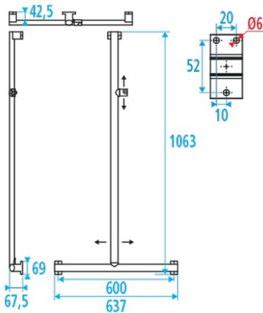
Modulable : convertible en L ou en T lors du montage initial. Une fois monté, ce positionnement reste fixe : 3 points de fixations.
