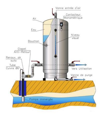
Un réservoir Hydrophore de capacité et de pré-gonflage équivalent à celui d'un réservoir à vessie aura exactement le même volume d'eau utile, conformément à la Loi de MARIOTTE
