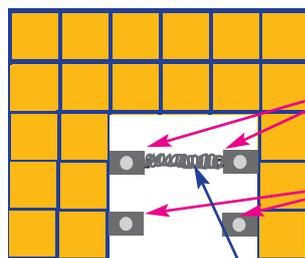
pattes avec crochet pour fixation du ressort aimant vers extérieur habillage
