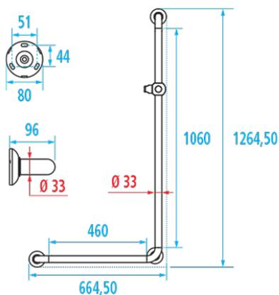
Multicomposants : résine de synthèse blanc + profil aluminium. Tube Ø 33 mm.
