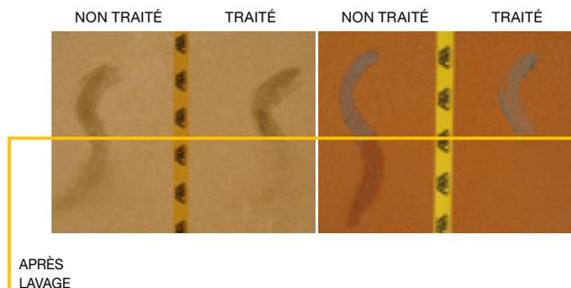
Test anti-taches effectué sur la pierre de Bourgogne et la terre cuite. Dans la section non traitée, le mortier est entré en profondeur en rendant le nettoyage difficile après la pose. Dans la partie traitée, le mortier n'a pas pénétré et a été facilement enlevé à l'aide d'un détergent spécifique.
