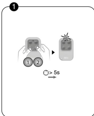
1 Appuyez simultanément 5 secondes sur les touches 1 et 2, jusqu'à ce que le voyant s'allume orange.
