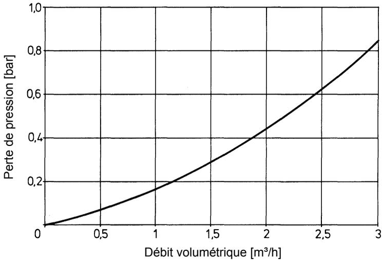
Fig. 15 : Perte de pression en position de service
