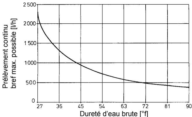
Fig. 17 : Prélèvement continu bref max. possible
