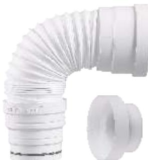
Pipe WC en PVC-PP universelle extensible en polypropylène, raccordements Ø 93 -100 -110 mm et Ø 80 avec réduction 100 - 80 mm à coller. Raccordement avec joint torique ou collage. Bagues et joint EPDM démontables. Permet un raccordement désaxé. Extensible de 250 à 550 mm horizontalement.
