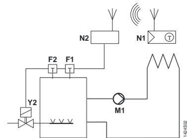
Thermostat d'ambiance sans fil avec récepteur pour piloter une chaudière gaz au sol
